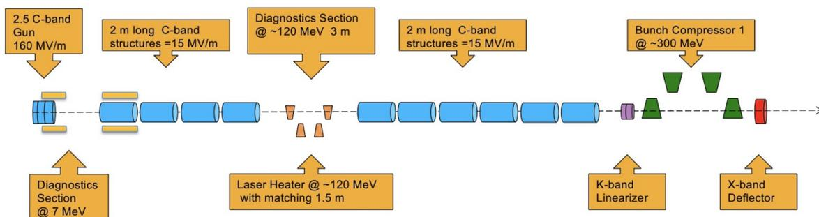
Figure 5.1.: Injector layout
